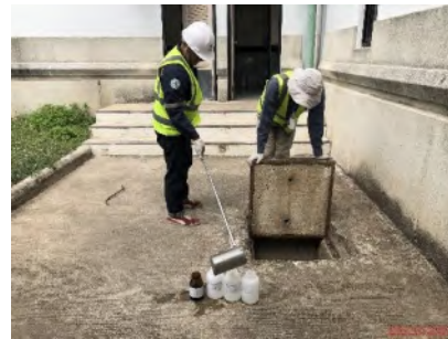
จุดเก็บน้ำบริเวณจุดระบายน้ำเสียหลังผ่านการบำบัดน้ำของอาคารที่พักผู้โดยสารหลังใหม่ขาออก
